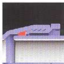
Csavaros, tokos csatlakozás DIN 28601 DN 80-400
