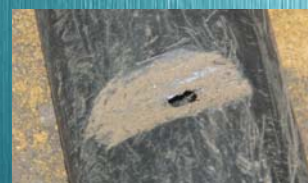
A feltárt csőhiba a polietilén csövön
